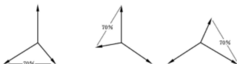
b) 三相系统相线对相线试验——可接受的相移方法 1
