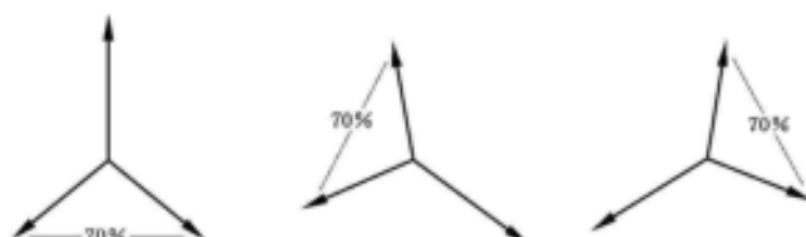
c) 三相系统相线对相线试验——可接受的相移方法 2
