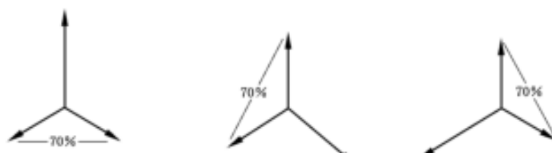
d) 不可接受的方法——相线对相线无相移试验
